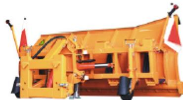
Zusätzliche PUR-Anschlagpuffer sorgen im Räumeeinsatz für eine Querpendelstabilisierung.
